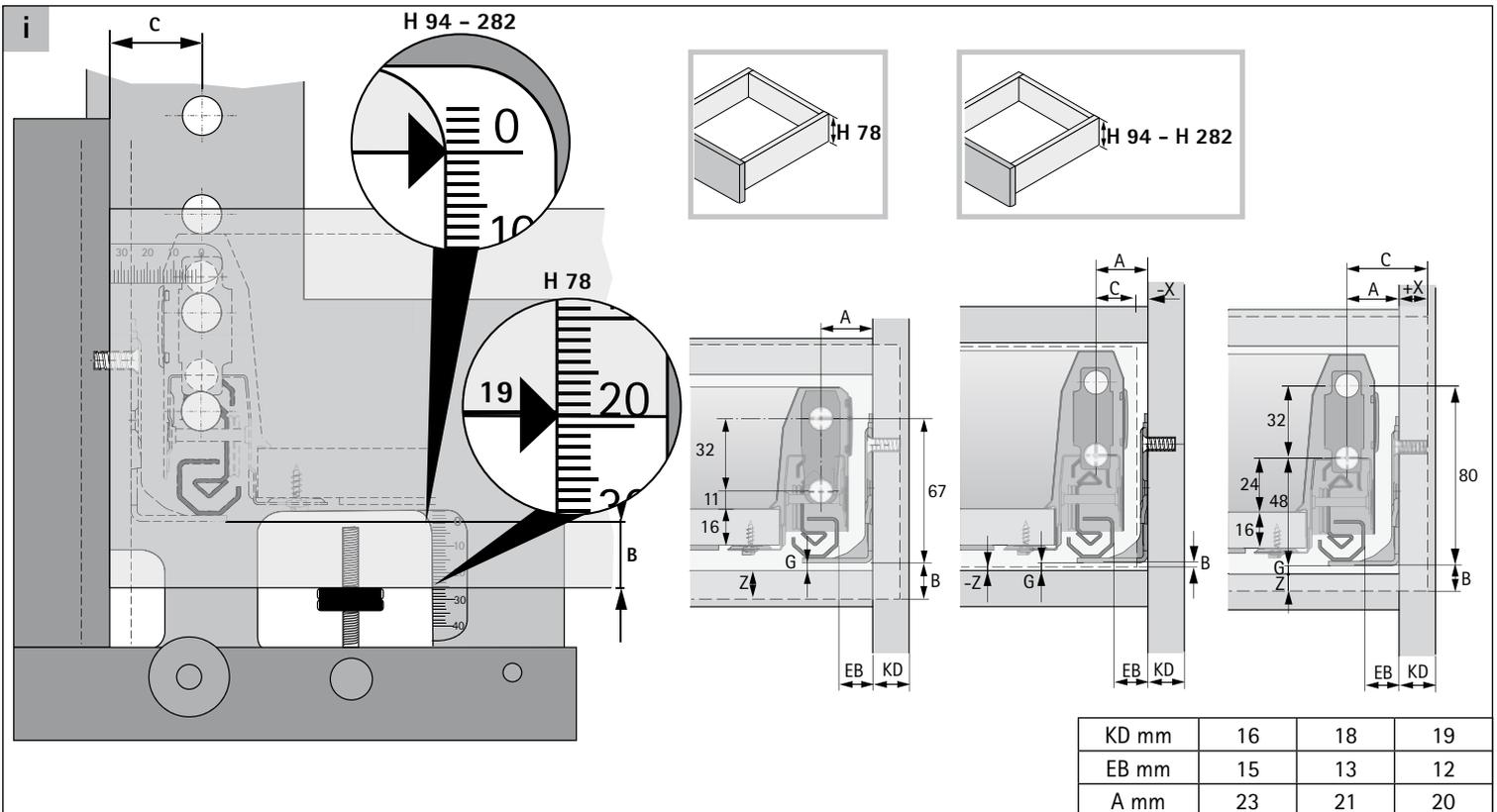
**D** A = Mitte Bohrung bis Innenkante Korpusseite
