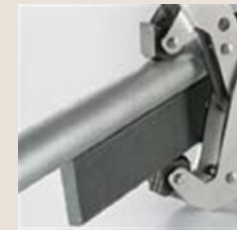
3 V-блок Подходит для захвата круглых деталей.
