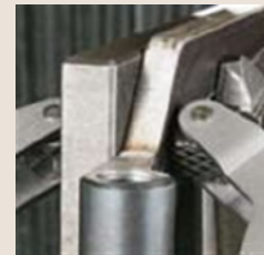
2 Шероховатая поверхность Увеличивает трение на поверхности прижима.
